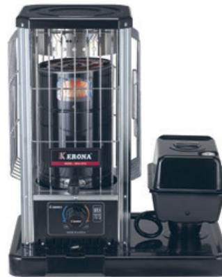
дельно от нагревателя, на общем поддоне, это повышает безопасность при заправке. Розжиг здесь ручной (чтобы поднести спичку к фитилю, нажимают на рычажок и приподнимают вытяжную трубу) и электрический — при нажатии на кнопку раскаляется вольфрамовая нить свечи накала и поджигает фитиль (свеча работает от двух батареек, поставляемых в комплекте). Модель предназначена для обогрева гаражей или складских помещений площадью до 45 квадратных метров.
